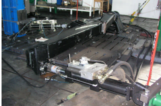
Bild 27: Zweizylinderprüfung an Ausleger der Firma Palfinger
